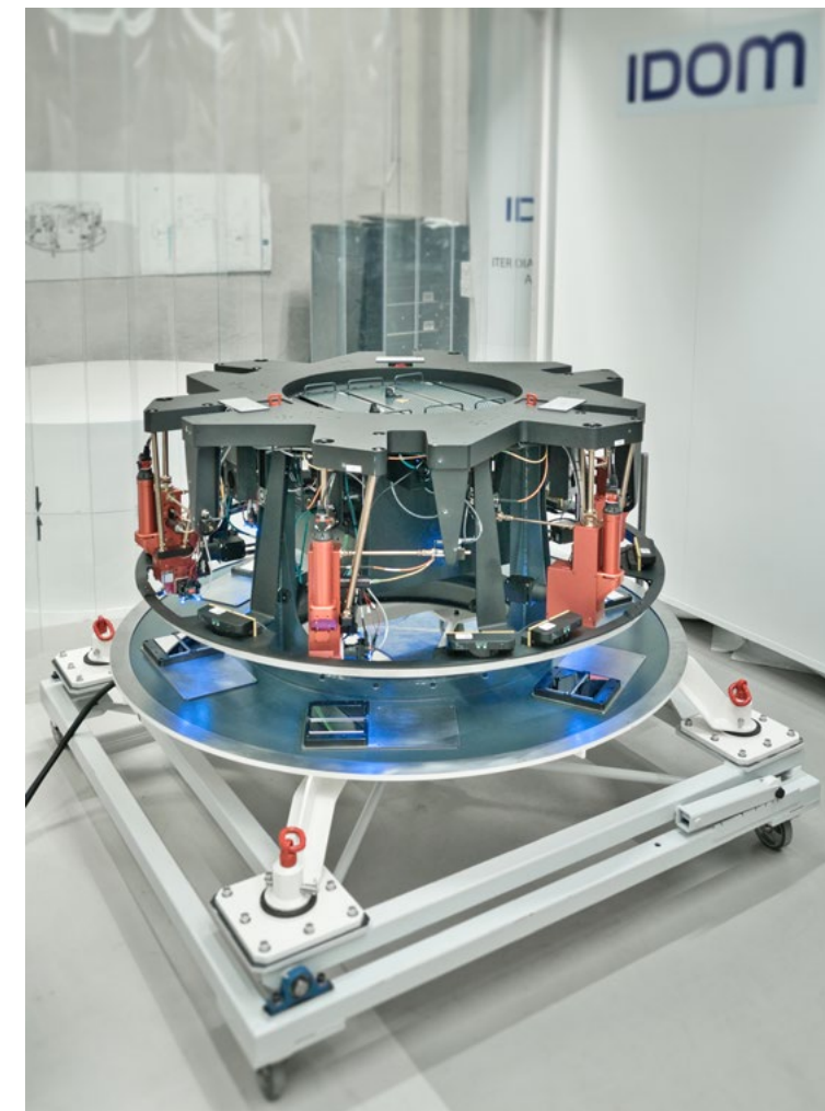
Local Coherencer: Interferòmetre òptic de coherència parcial per mesurar el posicionament relatiu dels segments del mirall primari del Extremely Large Telescope de l'European Southern Observatory.
