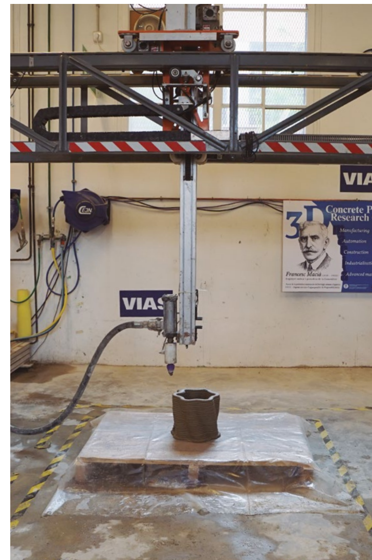
Equipament d'impressió 3D amb formigó.
